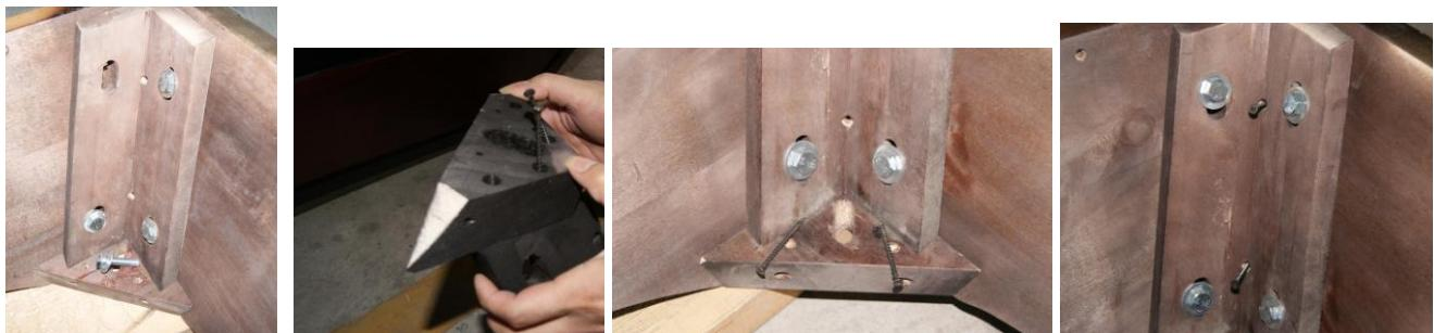
Prvo sastavite stranice kućišta stola s drvenim nosačem, a zatim umetnute kutni blok.
